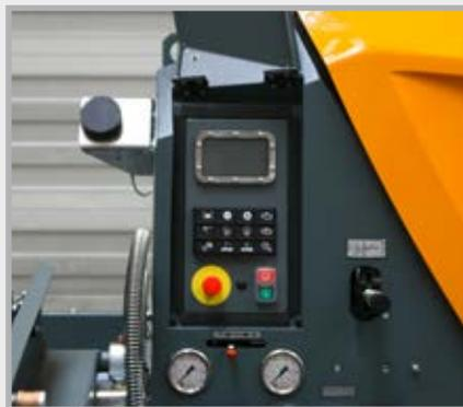
Il pannello di comando centrale con tastiera di comando intuitiva aumenta la sicurezza di comando. Un display ben visibile fornisce all'utente tutte le informazioni di rilievo.
