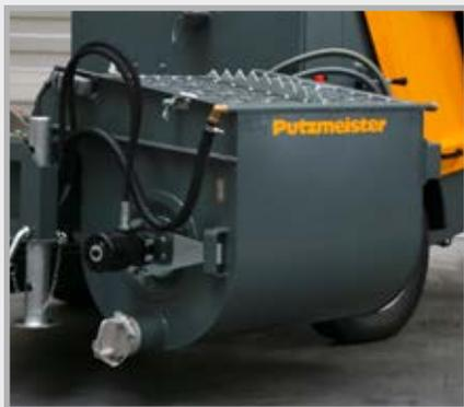
Le grand malaxeur d'un volume de 240 l équipé d'une rampe d'eau intégrée permet le malaxage de grandes quantités de matériaux sur les chantiers.
