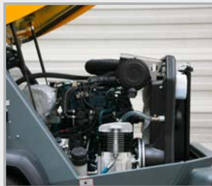
Il potente motore diesel da 28 kW con filtro antiparticolato per motori diesel soddisfa il livello di emissioni „Stage V“. L'aria necessaria in caso di applicazioni a spruzzo viene fornita dal compressore montato.
